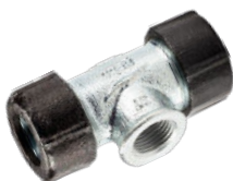
ТИП QT КОМПРЕСІЙНИЙ ФІТИНГ ТИПУ "ТРІЙ- НИК", ЗАЖИМНЕ КІЛЬЦЕ З ОБОХ СТОРІН, ВІДВІД З ВНУТРІШНЬОЮ РІЗЬБОЮ
